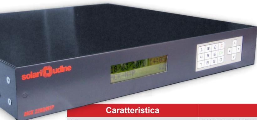
Master Clock con interfaccia Ethernet che consente di pilotare una rete di orologi via NTP oppure attraverso 4 linee a impulsi di cui è dotato. Dispone anche di 6 linee di segnalatori e dell'interfaccia GPS.
